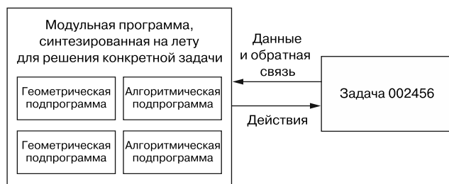
Рис. 14.12. Программа, сгенерированная одновременно на основе геометрических (распознавание шаблонов, предсказание) и алгоритмических (рассуждения, поиск, память) примитивов
