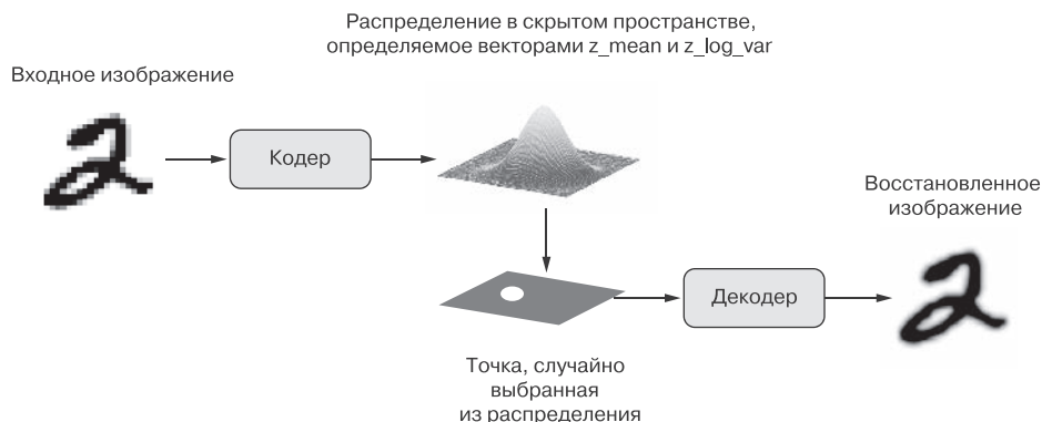
Рис. 12.17. Вариационный автокодировщик отображает изображение в два вектора, z_mean и z_log_sigma , которые определяют распределение вероятности в скрытом пространстве, используемое для выбора точки для декодирования
