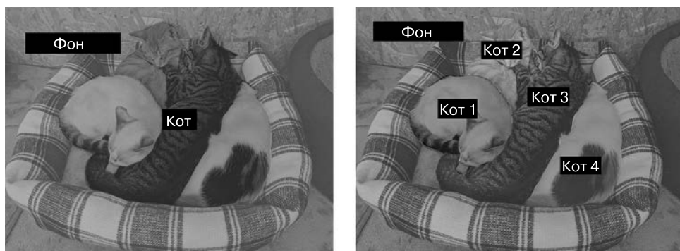
Рис. 9.2. Семантическая сегментация и сегментация экземпляров
